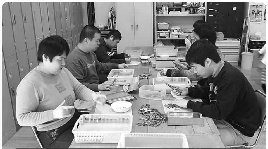
【点火製品組立・ナンバリング作業】 ガスレンジの取手部分の部品をベンチで組み立てて、部品番号のスタンプを押します。
